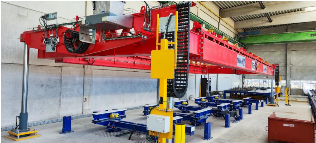
Figura 2: Na produção de paredes duplas, um dispositivo estacionário de giro de paletes Vario TURN garante um processo de giro e semiautomático.
