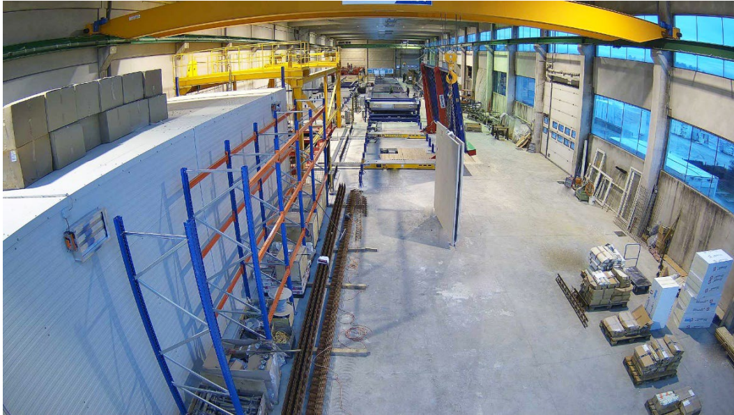
Figura 5: O espaço extremamente compacto da nova produção de parede dupla na Josef Lehner é uma característica especial.
